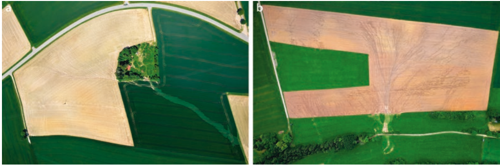
Abb. 5.2 Massive Bodenabschwemmungen aus Maisfeldern und Abfluss in Tiefenlinien nach Starkregenereignissen vom 06.06.2016 (a) und 04.06.2016 (b) im Gebiet zwischen Hemau und Laaber (Bayern). In der linken Hälfte des rechten Luftbildes wurden Abflusskonzentration (kein baumartig verzweigtes Netz aus Fließpfäden) und Erosion weitgehend durch die Grünlandparzelle verhindert. (Quelle: W. Bauer, Agroluftbild Obertraubling in [3])
