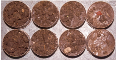
■ Abb. 2.4 Zunehmende Verschlammung einer ungeschützten Bodenoberfläche nach 1 mm, 30 mm, 40 mm und 70 mm Niederschlag (von links nach rechts). (Foto: K. Auerswald)
