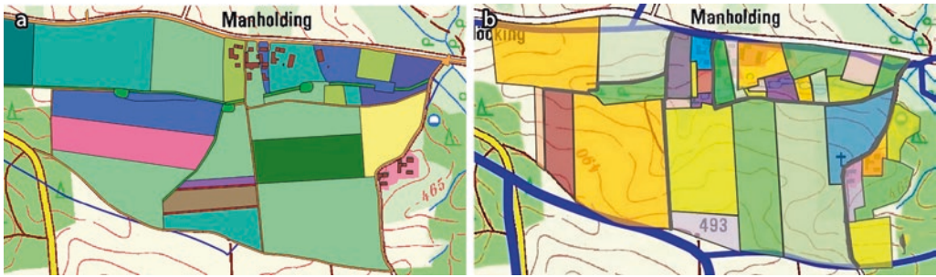
■ Abb. 6.20 Entwurfsplanungen zur Flächenparzellierungen eines Landschaftsausschnitts im Tertiärhügel-land. Die Farben markieren die verschiedenen Besitzverhältnisse. Die linke Variante (a) berücksichtigt Aspekte und Maßnahmen zum Wasser- und Stoffrückhalt. Die rechte (b) zeigt die konventionelle Planung, ohne explizite Berücksichtigung dieser Aspekte. Im virtuellen Entwurf berücksichtigte Maßnahmen zum Wasserrückhalt sind die hangparallele Ausrichtung der Felder, drei Rückhaltebecken (grüne Ovale), eine begrünte Abflussmulde (dunkelgrüner, mittig von unten zum mittleren Rückhaltebecken verlaufender Linienzug), aufgeweitete Entwässerungsgräben (kurze, dunkelgrüne Linienzüge im Talweg) sowie zwei Terrassenstufen im Süden des Gebietes (dunkelrote Linien). Die blauen Linien in der rechten Tafel zeigen den Verlauf der Wasserscheide. (Verändert nach [60])
