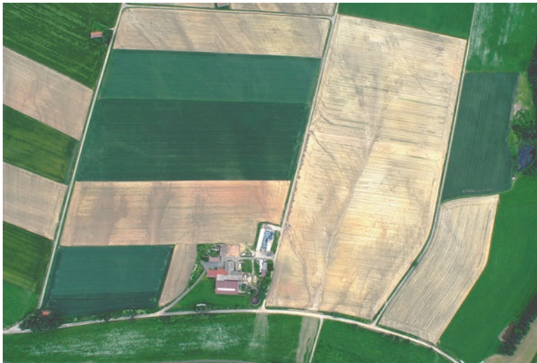
► Abb. 4.12 Luftbildaufnahme einer Hanglage nach einem Stundenniederschlag von 18 mm am 10.06.2011. Trotz Querbearbeitung kam es in dem langgestreckten Maisfeld (rechte Bildhälfte) zu Hangmuldenabfluss und starkem Bodenabtrag (Schwämmfächer unten rechts). In der linken Bildhälfte wurde eine stärkere Bodenerosion und die Ausbildung eines konzentrierten Hangmuldenabflusses durch den Fruchtartenwechsel und die dort auftretende, höhere Infiltration sowie die reduzierte, kritische Hanglänge verhindert (Quelle: W. Bauer, Agroluftbild)
