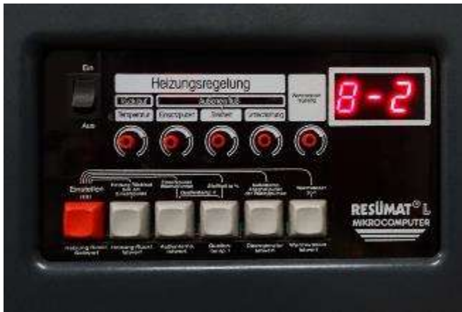
Abbildung 6: WP-Regler über Potentiometer einstellbar
