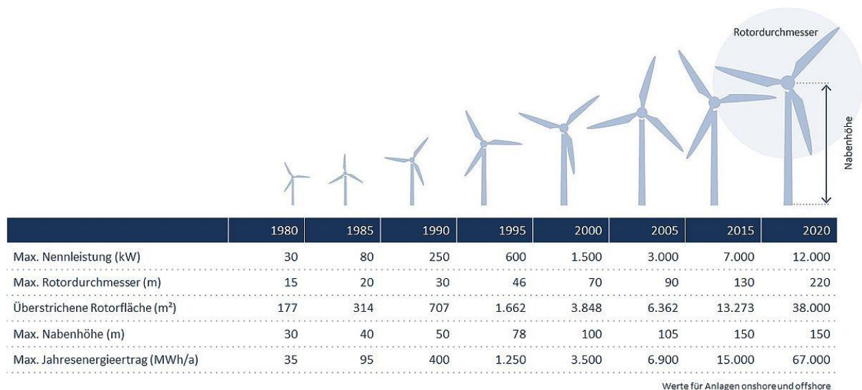
Abbildung 26: Entwicklung der Windkraftanlagen über die letzten 40 Jahre (offshore & onshore Windkraftanlagen)
