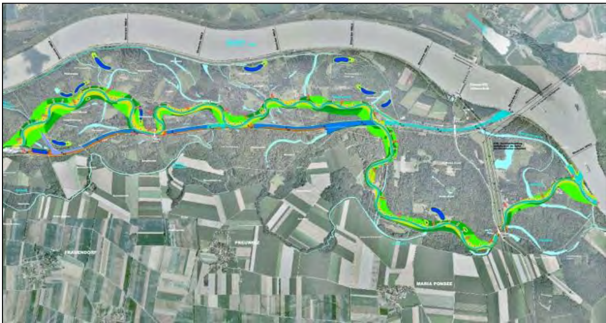
Abbildung 1: Maßnahmenplan des Renaturierungsprojektes Life+Traisen, (blau: neues Mittelwasserbett, gelb: HQ1-Bett, hellgrün:Umlandabsenkungen, dunkelgrün: Pufferzonen, hellblau: bestehende Altarme), Auweiher (dunkelblau) (SCHMALFUß 2010,17).
